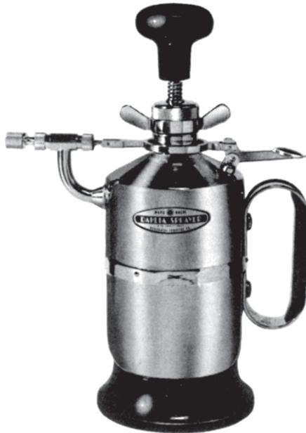
Hochwertiges Sprühgerät aus verchromtem Messing. Der Sprüh-Mechanismus und die Pumpe sind mechanisch äußerst stabil gebaut. Die Sprühdüse ist einstellbar und erzeugt einen sehr gleichmäßigen und feinen Sprühnebel; Tropfen-Bildung wird weitgehend verhindert. Die DAHLIA - Sprühgeräte sind ein ideales Instrument für Restauratoren zum Befeuchten von Papier, sowie zum Versprühen von flüssigen Chemikalien, wie z.B. Entsäuerungs-Lösungen.
